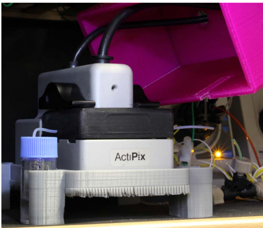
Figura 3.10. Fotografia del detector UV ActiPix D100. Les peces fúcsia i gris presents a la part superior i inferior formen la caixa d'aïllament per al detector. La finestra del capil·lar es troba al cartutx negre. El vial blau és on es submergeix la sortida del capil·lar i a on es col·loca l'elèctrode per a l'aplicació d'alt voltatge. A la dreta del detector es pot observar la interfase (peça negra).
