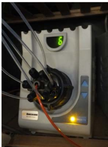
Figura 3.7. Fotografia de la vàlvula de 6 posicions amb 7 ports que selecciona la solució mare d'electròlit. Els tubs transparents són l'entrada i el tub taronja la sortida. En aquest cas, la fotografia mostra la selecció 6, que representa la succió d'electròlit NaCAPS 0.25 M.
