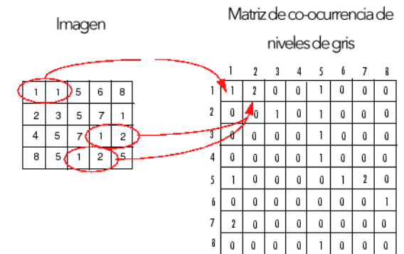
Figura A.9. Cálculo de la matriz de co-ocurrencia de niveles de gris de una imagen de 4 x 5 píxeles.
