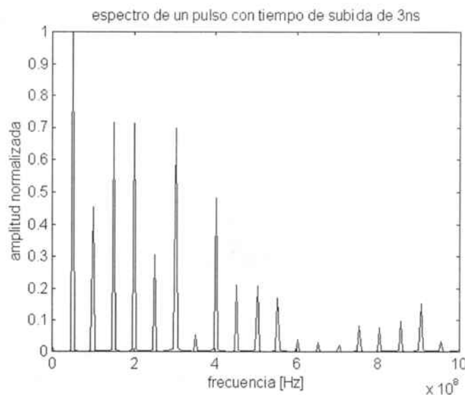
Figura VI.1: Espectro de un pulso a la entrada del ASD-8.
