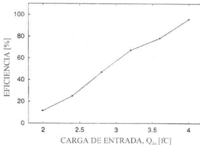
Figura V.5: Eficiencia del ASD-8 para un valor de threshold equivalente a 3 fC.
