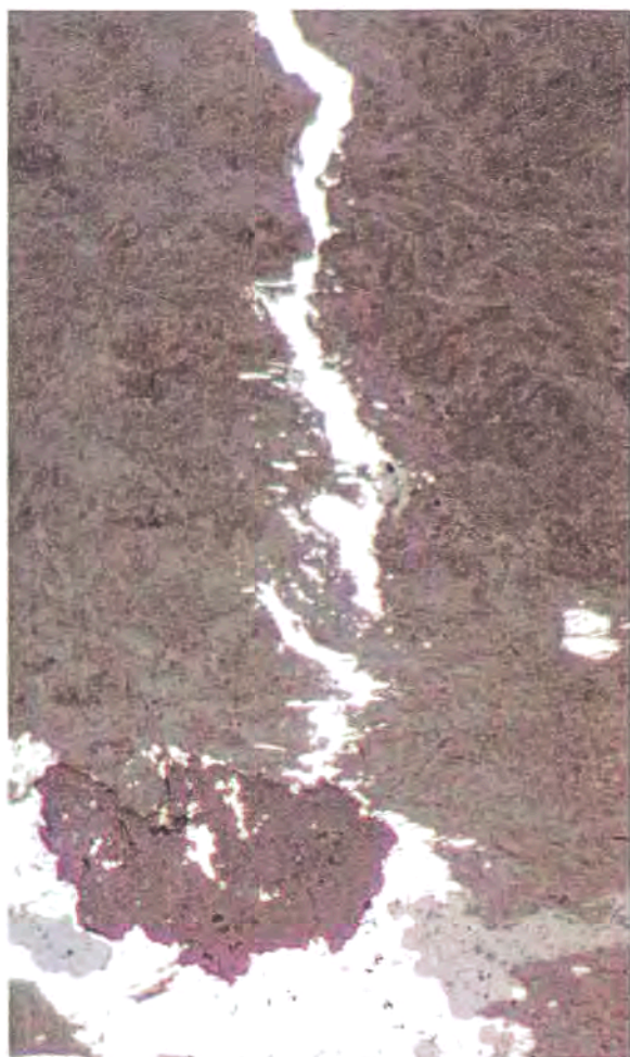
Figura 4.40. Veta de galena afectada per l'esquistositat. Llum reflectida, sense analitzador. Amplitud camp = 700 \mu\text{m} .
