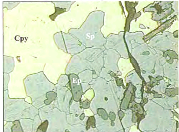
Figura 4.16. Textura granoblàstica entre esfalerita (Sp) i calcopirita (Cpy), acompanyades d'epidota (Ep). Llum reflectida. Camp = 1,2 mm.
