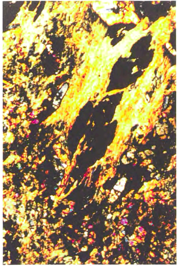
Figura 4.22. Ferroactinolita amb epidota i sulfurs. Els cristalls de ferroactinolita estan arranats seguint una foliació. Llum transmesa, amb analitzador. Amplitud camp = 225 \mu\text{m} .
