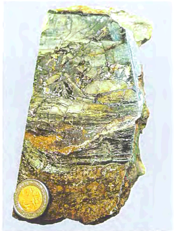
Figura 5.10. Aspecte de visu de la mineralització en bretxes (fàcies 5). Es distingeixen els clasts de roca feldspàtica, i el ciment, constituït per sulfurs grollers (esfalerita, pirrotita i galena).
