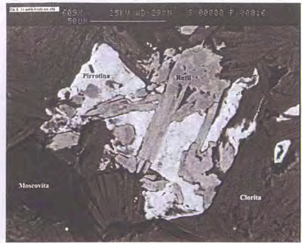
Figura 6.21. Cristalls de rútil dels nivells de clorita, amb pirrotita i moscovita. Imatge de SEM-BSE.
