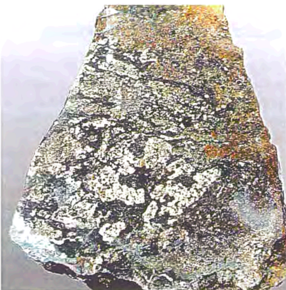
Figura 6.38. Detall dels nivells rics en pirita, associats també a calcosilicats. Amplitud del camp = 11 cm.
