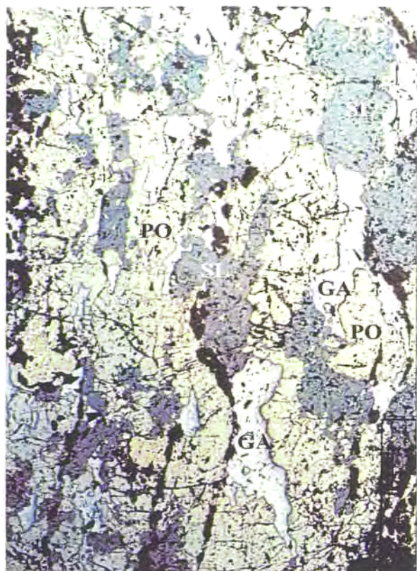
Figura 5.14. Microfotografia de la textura dels sulfurs massissos estructurats. S'aprecia la disposició elongada dels grans degut a l'esquistositat, particularment en els grans de galena. Llum reflectida, sense analitzador. Longitud de l'escala = 100 mm. GA: galena; PO: pirrotita; SL: esfalerita.
