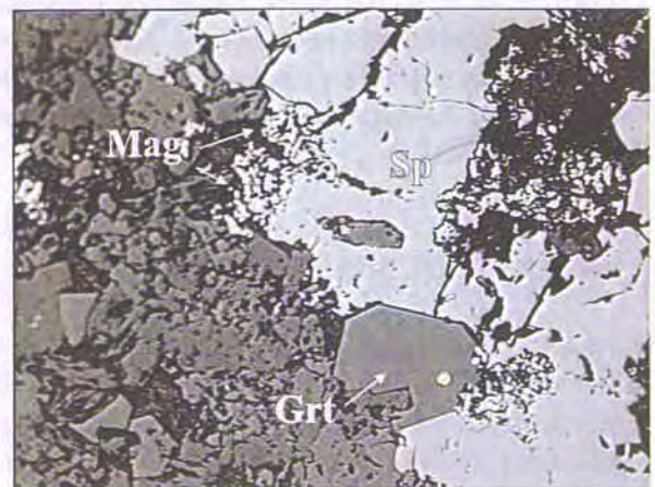
Figura 6.44. Reemplaçament d'esfalerita (Sp) i granat càlcic (Grt) per magnetita (Mag). Llum reflectida, sense analitzador. Amplitud del camp = 1,25 mm.
