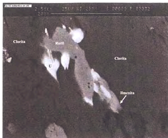
Figura 6.24. Uraninita (U) associada a rútil i ilmenita en nivell clorític. Imatge de SEM-BSE.
