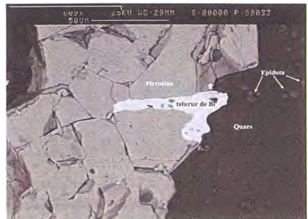
Figura 6.12. Tsumoïta (telurur de Bi) intersticial entre grans de pirrotita. Imatge SEM-BSE.
