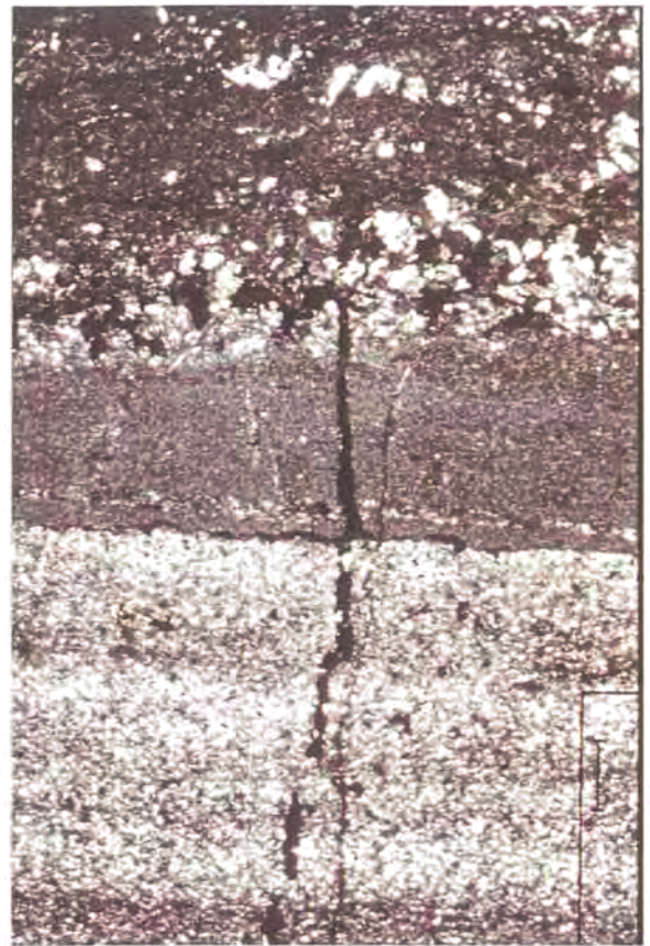
Fig. 5.16. Bandat litològic definit pels nivells de silicats i sulfurs. El tram gris central correspon a un nivell feldspàtic. La part inferior és rica en quars detrític, i la part superior correspon a un nivell de sulfurs massissos. S'observa també la remobilització dels sulfurs envers vetes. Llum transmesa amb analitzador. Longitud de l'escala = 100 \mu\text{m} .
