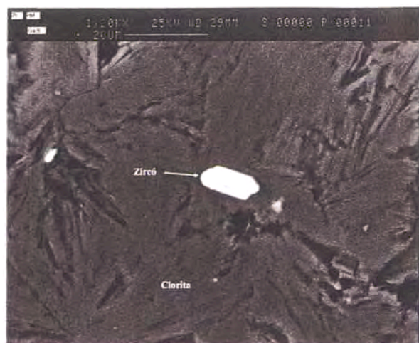
Figura 6.23. Cristall idiomorf de zircó en nivell clorític. Imatge de SEM-BSE.
