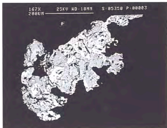
Figura 6.28. Cristall de scheelita (to més fosc) reemplaçat per stolzita (diverses composicions, tons més clars). Imatge de SEM-BSE.
