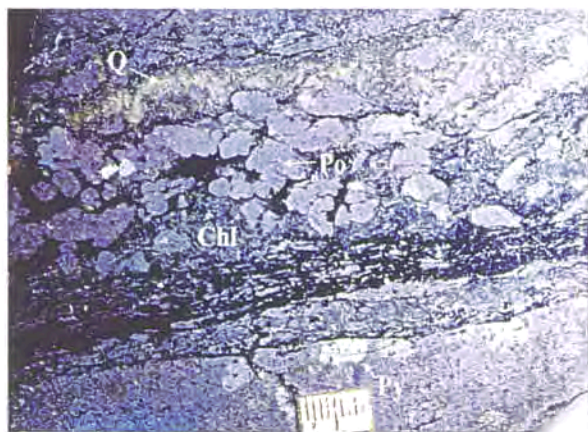
Figura 6.11. Detall d'un nivell de sulfurs massissos, amb pirrotita (Po), pirita (py), quars (Q), i clorita (Chl).
