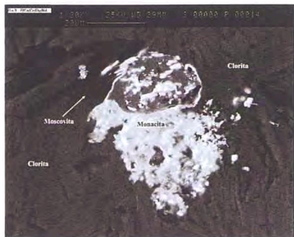
Figura 6.25. Agregat criptocristal·lí de monazita en nivell clorític. Imatge de SEM-BSE.
