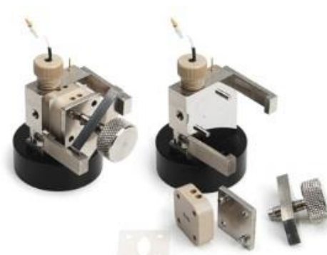
Figura 17. Cel·la de flux formada per un sistema de tres elèctrodes [157].
