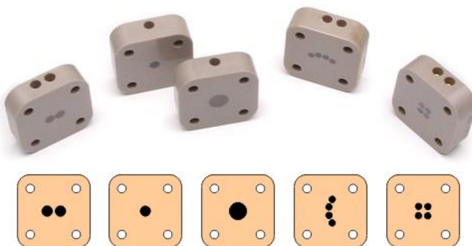
Figura 15. Exemples d'elèctrodes de treball per a detecció electroquímica disponibles comercialment on les superfícies electroactives són els discs de color negre [159].
