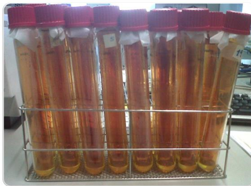
Figura 35. Atac àcid de les mostres en tubs de vidre per a la determinació del contingut total de metalls.
