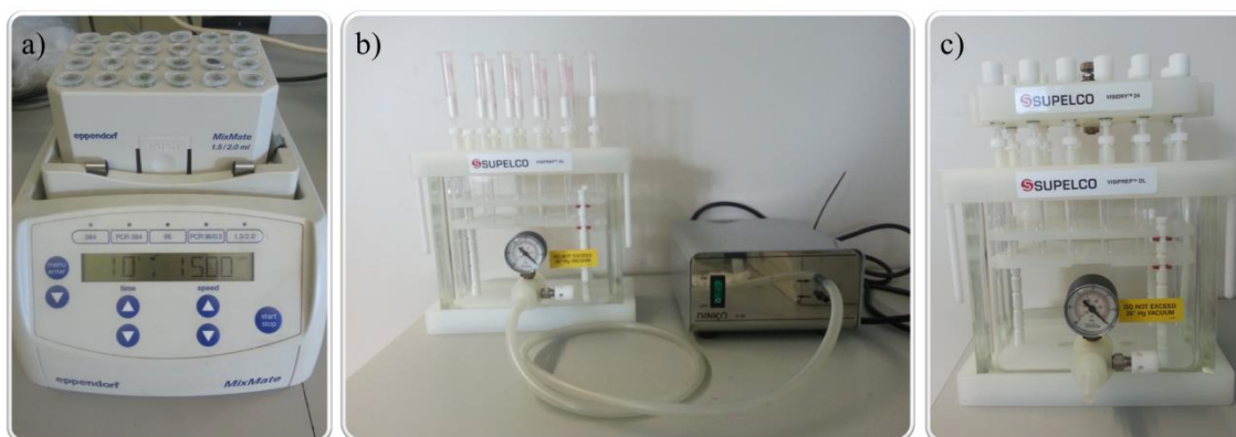
Figura 32. Instruments utilitzats en l'extracció, l'extracció en fase sòlida i l'evaporació de les mostres: a) MixMate; b) Visiprep DL Vacuum Manifold; c) Visidry Drying Attachment.
