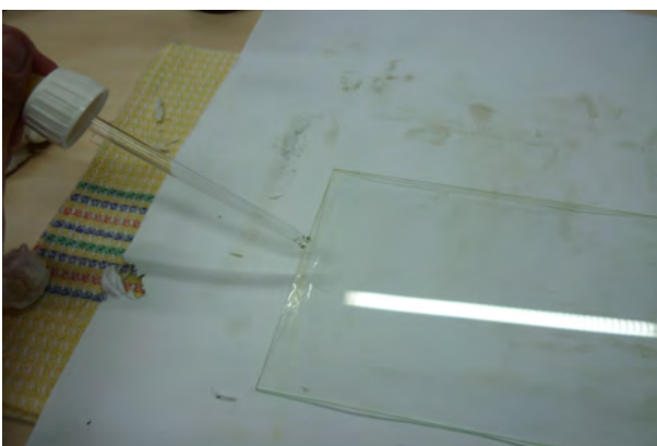
-Netejar els vidres que aguantaran el negatiu trencat.
