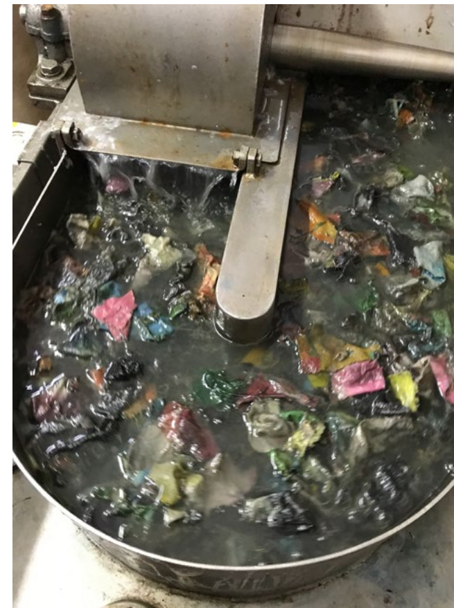
(Fig. 67) Elaboració pròpia, detall del moment de la trituració dels fragments de drap a la pila holandesa, 2024
