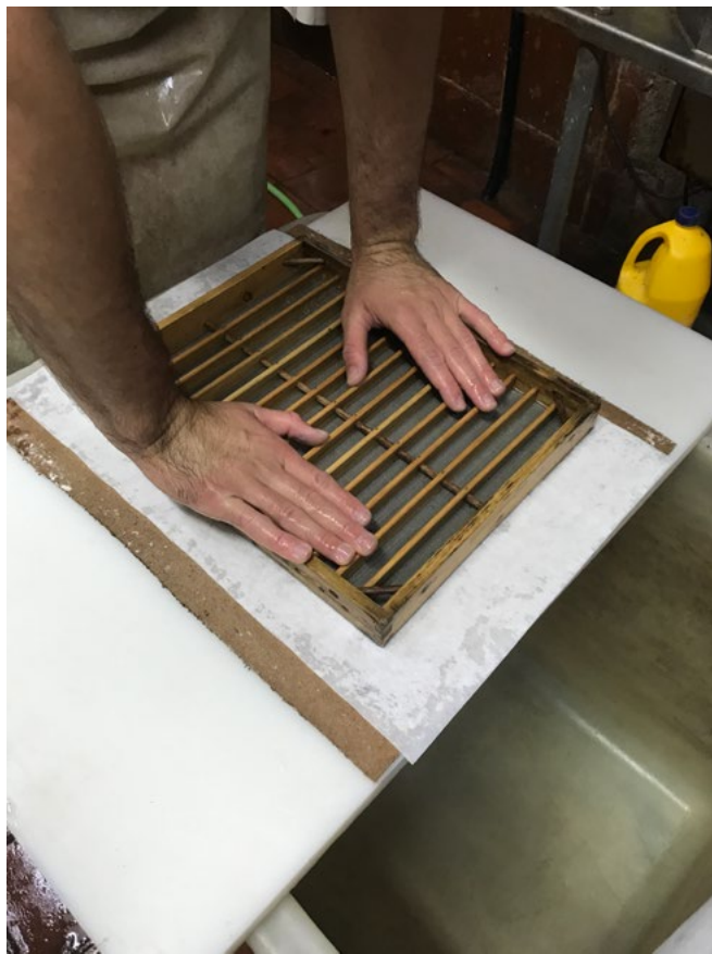
(Fig. 65) Elaboració pròpia, detall del moment en què en Ludger pressiona la forma sobre el sellal, 2024.
