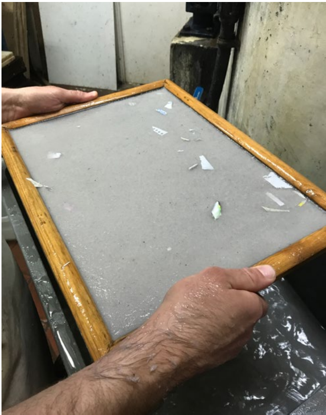
(Fig. 59) Elaboració pròpia, detall de la forma amb la pasta acabada de formar amb la tècnica del jaspiat, 2024.
