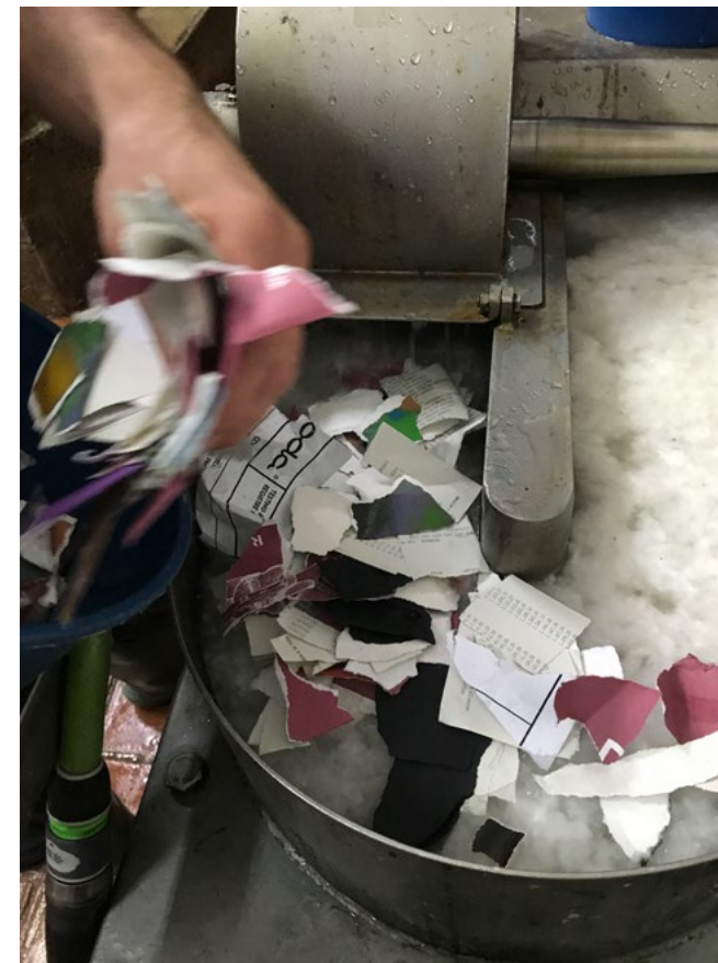
(Fig. 63) Elaboració pròpia, detall de la introducció del paper residual sobre la fibra de cotó en la pila holandesa, 2024.
