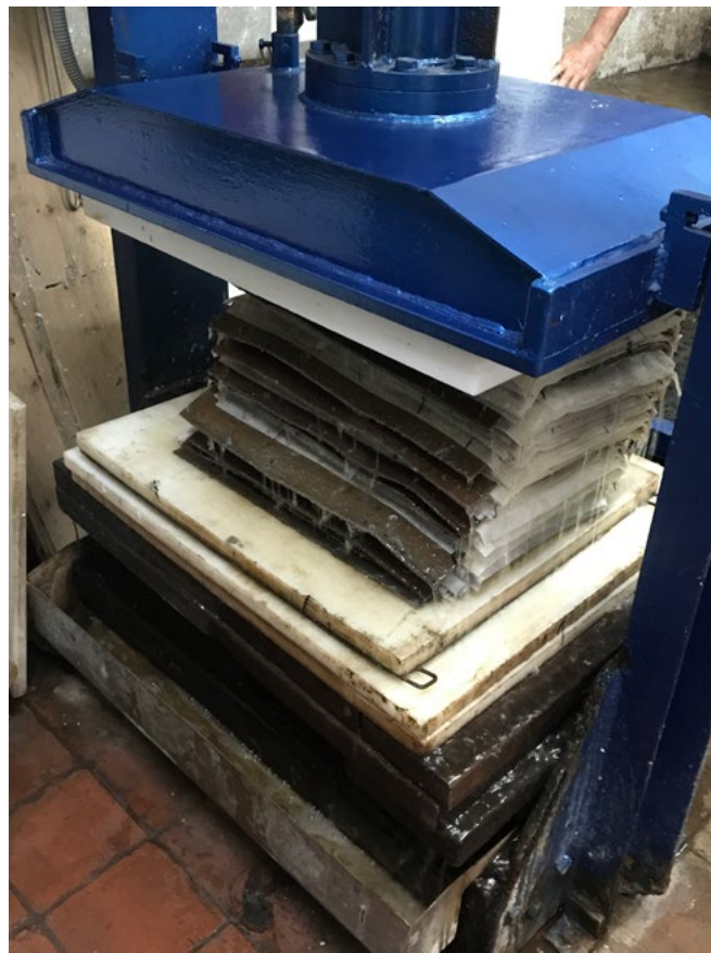
(Fig. 66) Elaboració pròpia, detall del moment en què el torn de la premsa efectua la pressió sobre una de les postes de paper per escórrer l'aigua, 2024.
