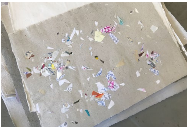
(Fig. 60) Elaboració pròpia, detall de la prova del paper amb la tècnica del jaspiat en tirar els fragments sobre la pasta de paper formada, 2024.
