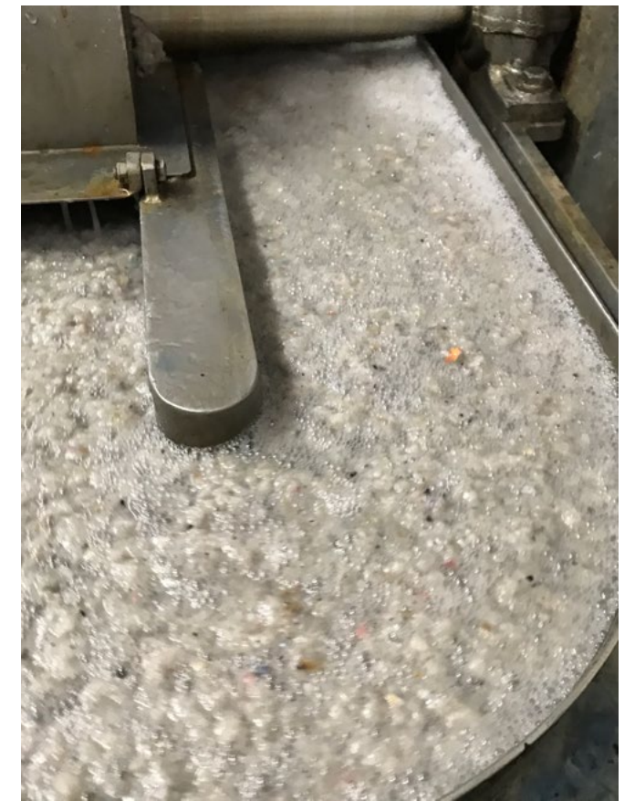
(Fig. 64) Elaboració pròpia, detall de la pasta de paper formada amb la fórmula completa i preparada per abocar a la tina, 2024.
