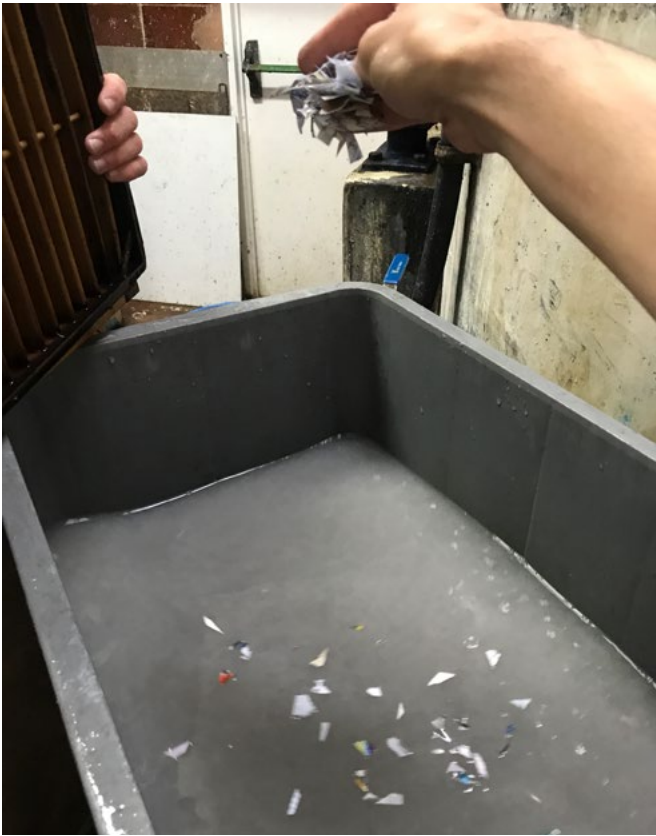
(Fig. 58) Elaboració pròpia, detall del moment en què s'afegeixen els trossos de paper a la tina on ja està preparada la polpa del paper, 2024.
