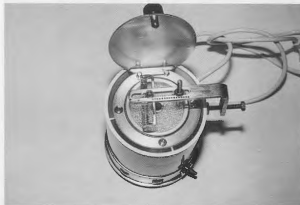
Figura 1. Esterilizador a bolas de vidrio. Para medir la temperatura se ha introducido el extremo de un termómetro electrónico de precisión, sostenido por un mecanismo mecánico que permite controlar la profundidad y distancia a la pared.
