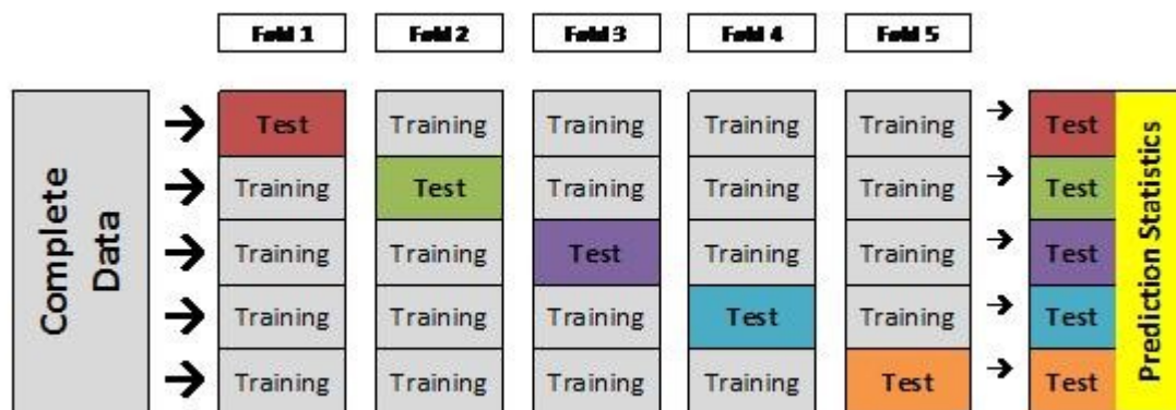
Figura 12: Diagrama del funcionamiento del K-Fold cross-validation . En este caso los datos son divididos en 5-folds.
