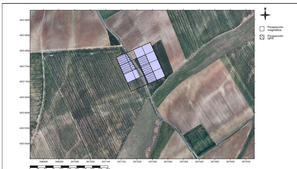
Imagen 1: Área de exploración sobre imagen aérea y zonas exploradas mediante los diferentes sistemas geofísicos: Gradiómetro magnético: 10.884,25m 2 (color), georadar antenas de 270MHz: 4.901m 2 (tramado).
