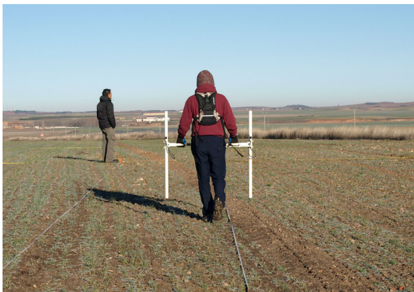
Imagen 2: Sistema de gradiometría magnética doble Bartington G601 con 1m entre los sensores.
