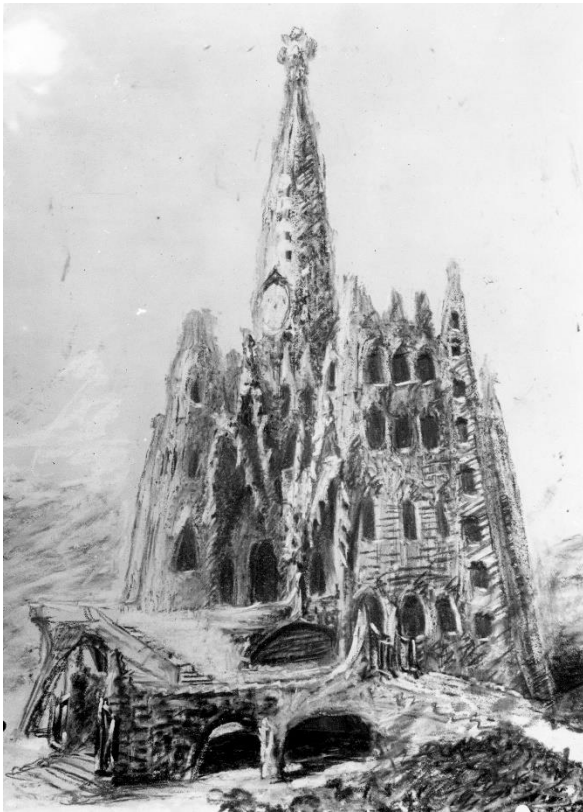
A sobre, imatge 20 (IAAH Arxiu Mas). Fotografia de la maqueta de la capella de la Colònia Güell. Vicenç Villarubias fotografiava la maqueta funicular, i Gaudí hi dibuixava al damunt i les acoloria
