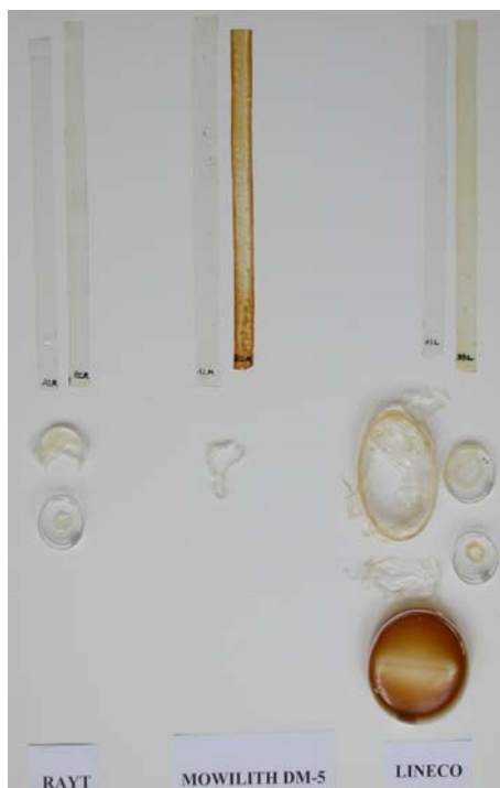
Foto 1. En la zona superior se observan las muestras de los 3 adhesivos: Rayt® (izquierda), Mowilith® DM-5 (centro), Lineco® (derecha). Cada adhesivo está representado por una muestra anterior (izquierda) y posterior (derecha) al envejecimiento acelerado. En la zona inferior se observan las muestras de los 3 adhesivos envejecidas de forma natural durante 10 años.
