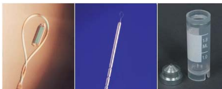
Figura 3.7 Sistema utilizado para congelar, conservar y analizar los cristales. Los cristales se montan dentro de un lazo de nailon ( loop ), situado en el extremo de un perno metálico ( pin ), el cual por el otro extremo se encuentra insertado en un cabezal magnético que servirá para situarlo en un goniómetro, y alinear el cristal dentro del haz de radiación de RX. Imagen adaptada de la página web de Hampton Research ( www.hamptonresearch.com ).
