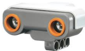
Figura 20: Descripción del sensor de ultrasonidos del Lego Mindstorms.
