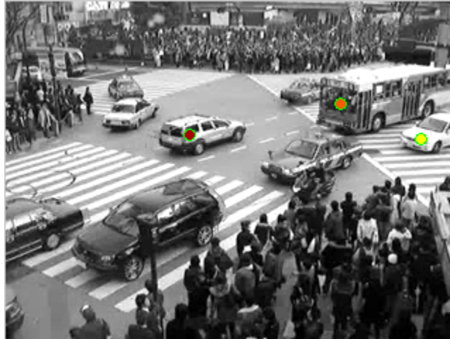
Figura 14: Tracking de vehículos mediante el algoritmo de Lucas-Kanade.
