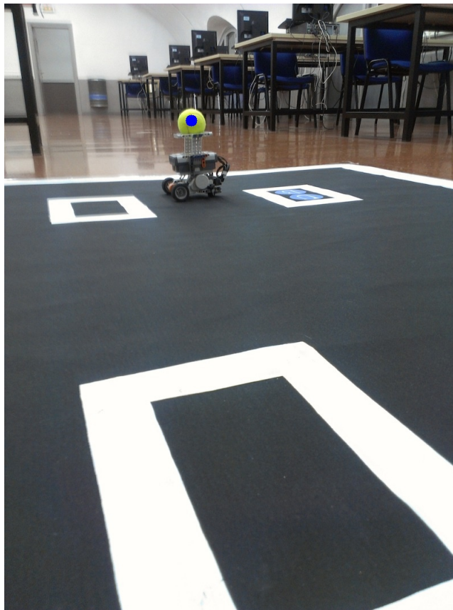
Figura 31: Imagen resultante del proceso de detección. El punto azul indica el punto en que se ha detectado la posición del objetivo.
