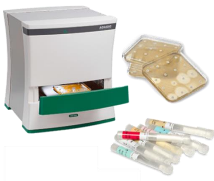
Figura 12. Sistema ADAGIO™ (Bio-Rad) es un dispositivo de imágenes automatizado que sirve para leer e interpretar automáticamente los resultados de los antibiogramas por disco-difusión ( derecha ). Tanto la interpretación de los resultados como los discos siguen las pautas y recomendaciones de EUCAST y/o CLSI. Imagen obtenida y modificada de http://bio-rad.com .
