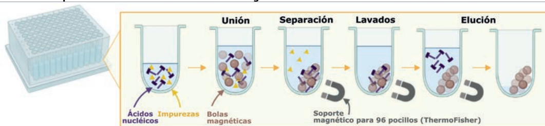
Figura 16. Esquema de la metodología de purificación de ADN mediante las bolas magnéticas AMPure XP (Beckman) y un soporte magnético de para placas de 96 pocillos (ThermoFisher). Figura realizada con www.biorender.com .
