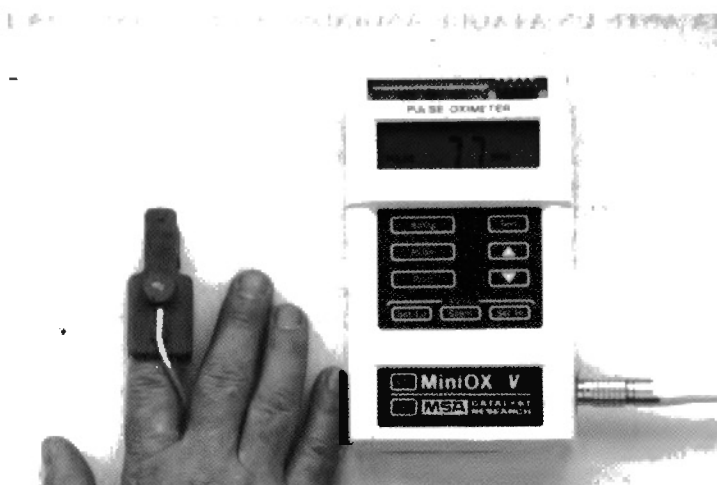
Fig. 2 Pulsioxímetro, para el registro de la saturación de oxígeno y la frecuencia cardíaca.
