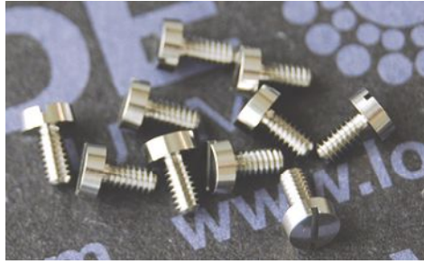
Fig. 3.3. Cargols de titani utilitzats com a electrodes. Grau: IV. Diàmetre del cap: 4 mm; rosca: M2
