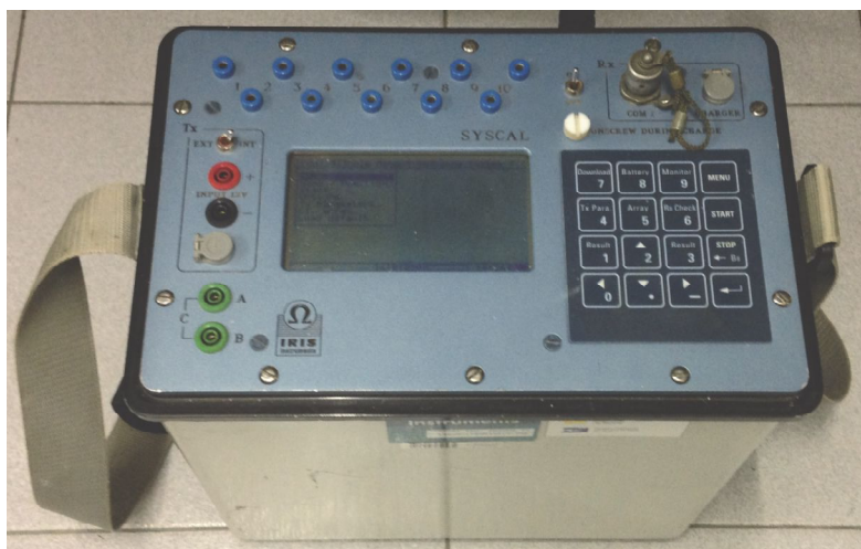
Fig. 3.6. Unitat d'adquisició de dades de tomografia elèctrica IRIS Syscal Pro Switch de 10 canals. Consisteix en un transmissor que permet aplicar un voltatge de fins a 800 V, un receptor que pot mesurar simultàniament en 10 canals amb una resolució d'1 \mu V i un multiplexor que distribueix el corrent pels canals requerits a la seqüència de mesures
