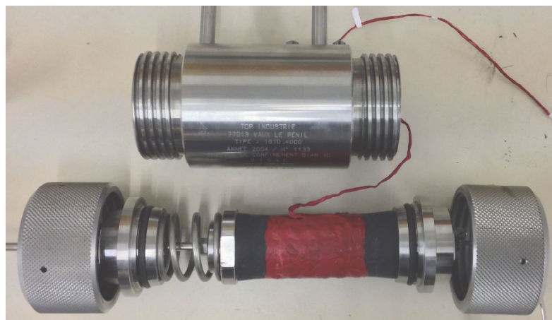
Fig. 4.4. Relació entre els èmbols i el tub de Viton que conté la mostra
