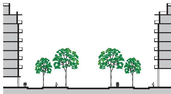
Figura 1.02: Sección transversal calle del Eixample, tipo: 50m.
