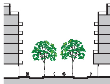
Figura 1.03: Sección transversal calle del Eixample, tipo: 30m.
