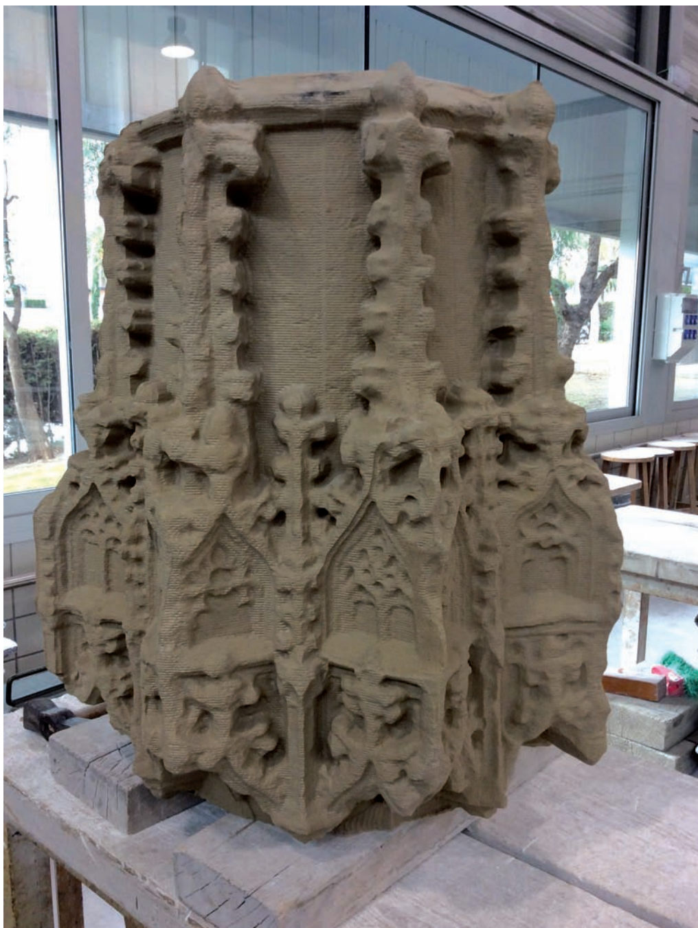
Figura 8. Resultat del treball de mecanitzat. Fotografia: Francisco Javier Lozano.
