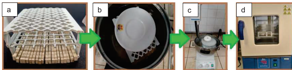
Figura 3.3 Tratamiento térmico de láminas de bambú a) Ubicación de probetas en rejilla plástica. b) peso sobre rejilla para mantener la inmersión. c) recipiente tapado. d) secado de probetas.
