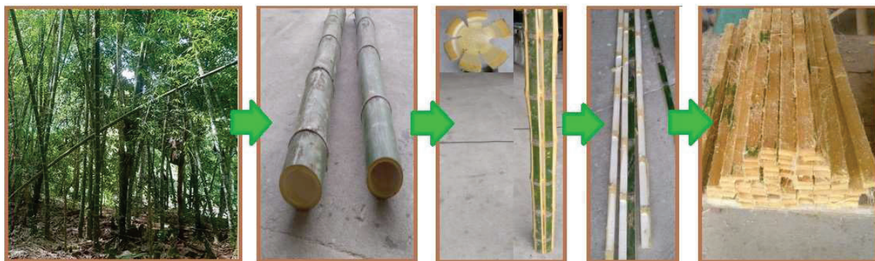
Figura 3.1 Proceso de acondicionamiento de láminas de bambú desde la plantación hasta obtener las láminas.
