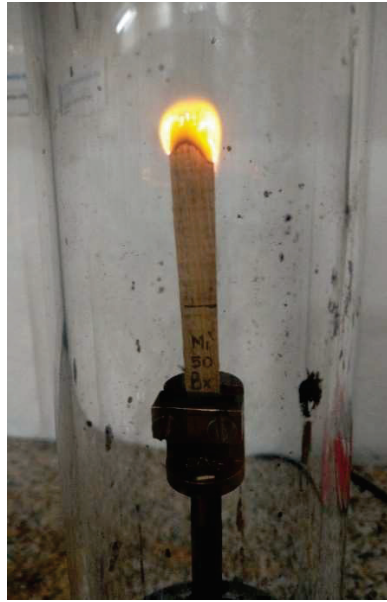
Figura 3.7 Ensayo de LOI de una lámina de GaK sometida al tratamiento TTQ60.
