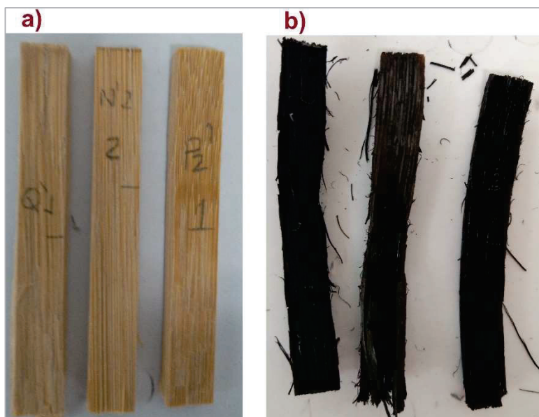
Figura 4.16 Probetas a) antes y b) después de la prueba de epirradiator.
