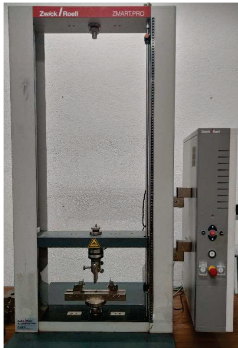
Figura 3.8 Máquina de ensayos universales Zwick/Roell.
