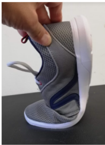
Figura 3.17. Sabata d'esport amb sola flexible i contrafort de poca duresa, marca Decathlon model Newfeel PW 100 "
