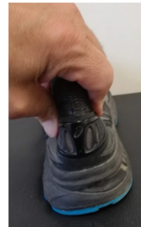
Figura 3.18. Sabata d'esport amb flexibilitat de la sola i duresa del contrafort mitjana marca ASICS model Mission
