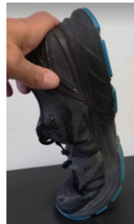
Figura 3.18. Sabata d'esport amb flexibilitat de la sola i duresa del contrafort mitjana marca ASICS model Mission
