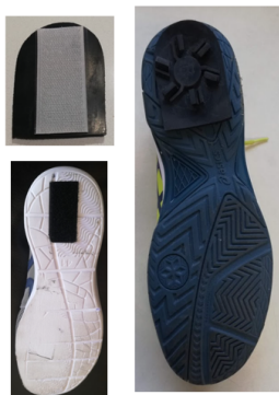
Figura 3.12. Adhesió del Torqheel al taló de la sabata mitjançant una veta adherent
