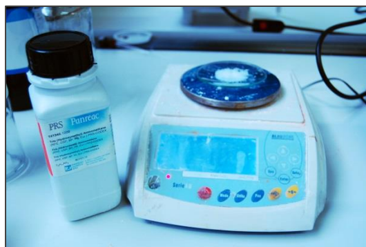
[98_12216_T_buffer.jpg] – Mesurament del Tris per donar un pH bàsic a l'aigua. Fotografia d'Emilse Parrello©.
