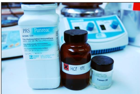
[97_12216_T_buffer.jpg] – Productes necessaris per preparar una solució tamponada bàsica amb tensioactiu dèbil. Fotografia d'Emilse Parrello©.
