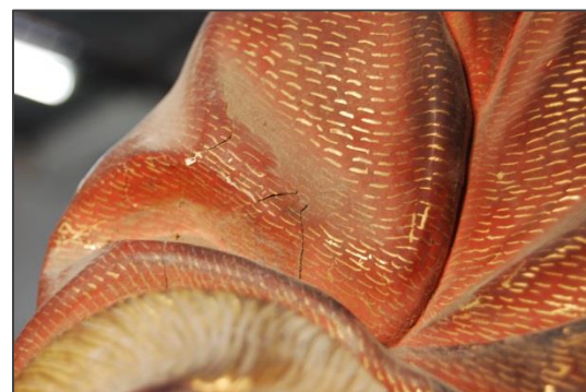
[25_12216_AT_diagnostic.jpg] Clivellats a la capa de preparació i pictòrica. Fotografies d'Emilse Parrello©.
