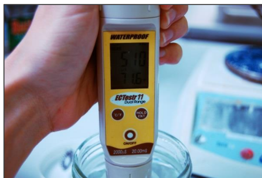
[102_12216_T_buffer.jpg] – Mesurament de la concentració iònica amb el conductímetre. Fotografia d'Emilse Parrello©.
