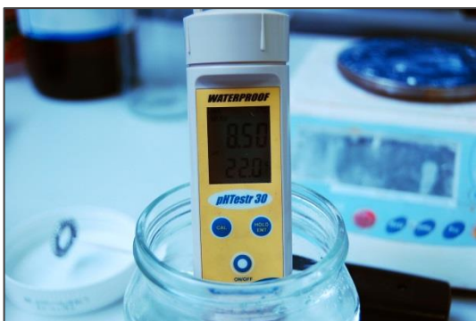
[101_12216_T_buffer.jpg] – Es deixa d'aplicar àcid clorhídric (HCl) quan s'aconsegueix el pH desitjat. Fotografia d'Emilse Parrello©.
