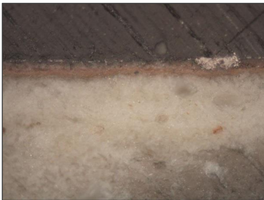
[21_12216_AT_analisis.jpg] – Estratigrafia de la zona platejada (M5) a 400 augments. Detall de la làmina metàl·lica. Fotografia de Ricardo Suárez de la Vega©.
