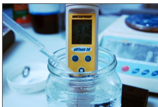
[100_12216_T_buffer.jpg] – Mesurament del pH de la solució amb el pHímetre. Fotografia d'Emilse Parrello©.
