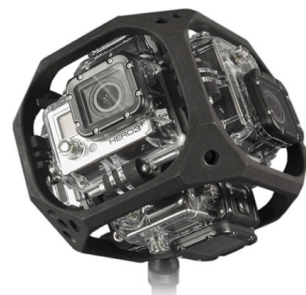
Figura 8. Rig F360 Explorer con 6 cámaras GoPro Hero3+.
