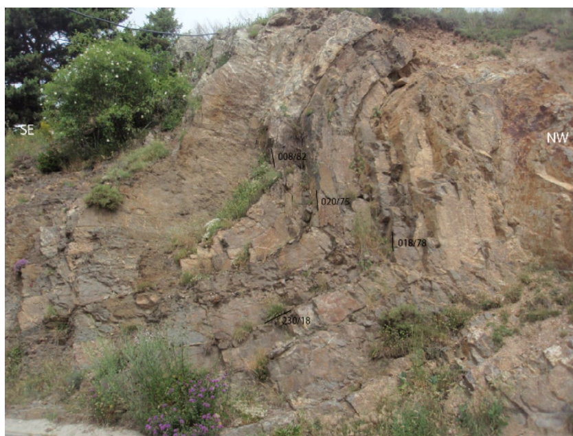
Figura 6.51: Plecs paral·lels en la Fm quarssita de Bar, a la carretera de la Moixella. Les mesures són d'estratificació.
