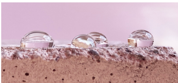
Figura 70 - Macro fotografia de gotes dipositades sobre la superfície d'una proveta. Segons la Norma, la distància entre les gotes ha de ser de més de 3 mm. © Maria Isabel Garcia Vilà
