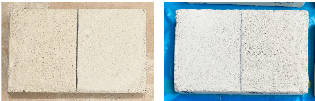
Figura 90 - (A l'esquerra) Aspecte de la proveta després del tractament amb Aquashield Ultimate®. Figura 91 - (A la dreta) Aspecte de la mostra després del tractament amb Tkrom®. © Maria Isabel Garcia Vilà
