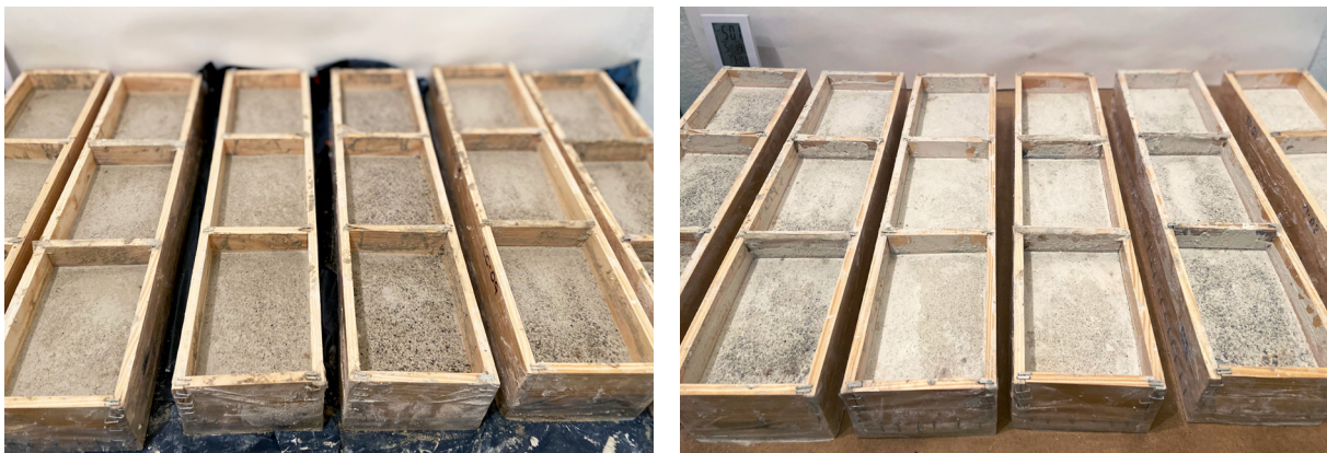
Figura 44 - (A l'esquerra) Provetes el primer dia d'assecatge. Figura 45 - (A la dreta) Provetes després de 28 dies d'assecatge. A simple vista, es poden observar els canvis de coloració experimentats durant el procés de carbonatació de les provetes. © Maria Isabel Garcia Vilà
