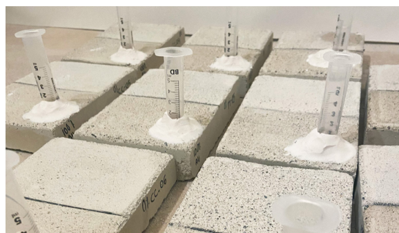
Figura 75 - (A l'esquerra) S'introdueixen 4 ml d'aigua a l'interior de la pipeta fent servir una xeringa. Figura 76 - (A la dreta) Procediment d'assaig per determinar l'absorció de l'aigua. © Maria Isabel Garcia Vilà
