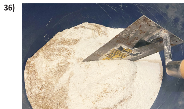
Figura 33 - Materials emprats per a la fabricació de les provetes. Figura 34 - Tamisat dels àrids de platja o riu. Figura 35 - Es pesen les quantitats necessàries amb una balança de precisió. Figura 36 - Igual que en el procediment anterior, es barregen en sec els àrids i la calç. © Maria Isabel Garcia Vilà
