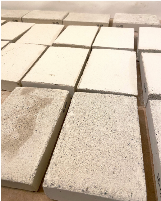
Figura 55 - A la fotografia es pot veure la diferència existent entre les provetes sense tractar i les provetes precondicionades. Figura 56 - Detall de la textura superficial de les provetes precondicionades. © Maria Isabel Garcia Vilà
