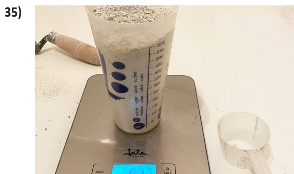
Figura 33 - Materials emprats per a la fabricació de les provetes. Figura 34 - Tamisat dels àrids de platja o riu. Figura 35 - Es pesen les quantitats necessàries amb una balança de precisió. Figura 36 - Igual que en el procediment anterior, es barregen en sec els àrids i la calç. © Maria Isabel Garcia Vilà
