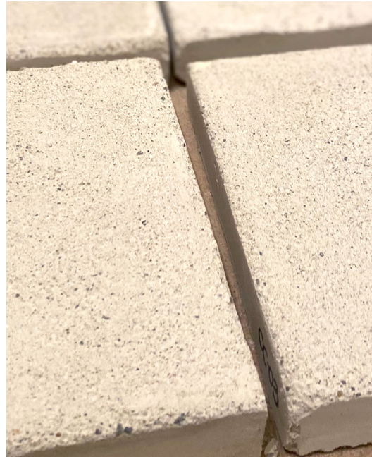
Figura 55 - A la fotografia es pot veure la diferència existent entre les provetes sense tractar i les provetes precondicionades. Figura 56 - Detall de la textura superficial de les provetes precondicionades. © Maria Isabel Garcia Vilà
