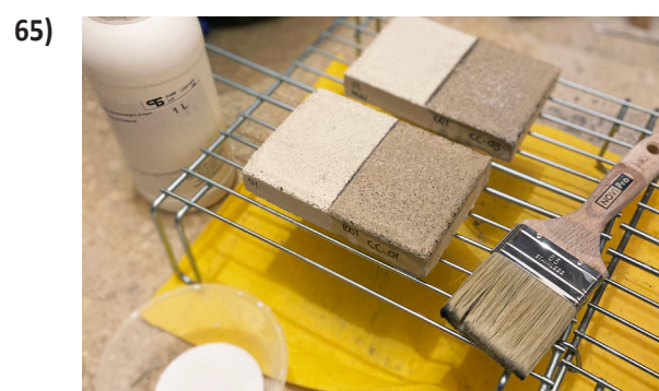
Figura 62 - Provetes abans d'aplicar el producte hidrofugant. Figura 63 - Aplicar el producte hidrofugant sobre la superfície mitjançant una paletina de cerdes naturals. Figura 64 - El producte s'ha d'aplicar fins que la superfície el refusi. Figura 65 - Provetes després de l'aplicació del tractament. © Maria Isabel Garcia Vilà
