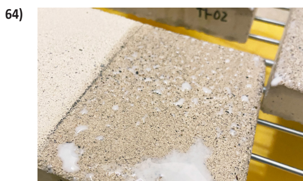
Figura 62 - Provetes abans d'aplicar el producte hidrofugant. Figura 63 - Aplicar el producte hidrofugant sobre la superfície mitjançant una paletina de cerdes naturals. Figura 64 - El producte s'ha d'aplicar fins que la superfície el refusi. Figura 65 - Provetes després de l'aplicació del tractament. © Maria Isabel Garcia Vilà
