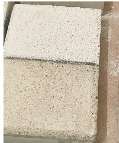
Figura 92 - Aspecte de la mostra després del tractament amb Nano Silo W®. © Maria Isabel Garcia Vilà
