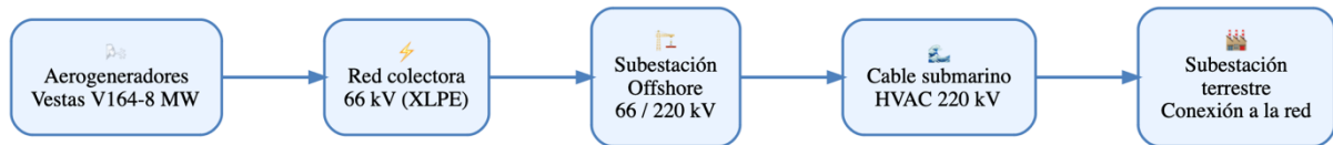
Figura 4.4. Esquema simplificado de la infraestructura eléctrica del parque eólico marino. (Fuente: Elaboración propia )
