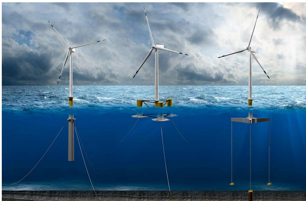
Figura 1.1: Tipos de plataformas flotantes en eólica marina (Fuente: Yale E360)
