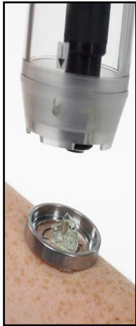
Fig. 14. Sistema de acoplamiento del microscopio confocal a la piel. Se realiza mediante un anillo de acero adherido a la piel por un adhesivo desechable y al microscopio por un imán. Gel acuoso utilizado como medio de contacto.
