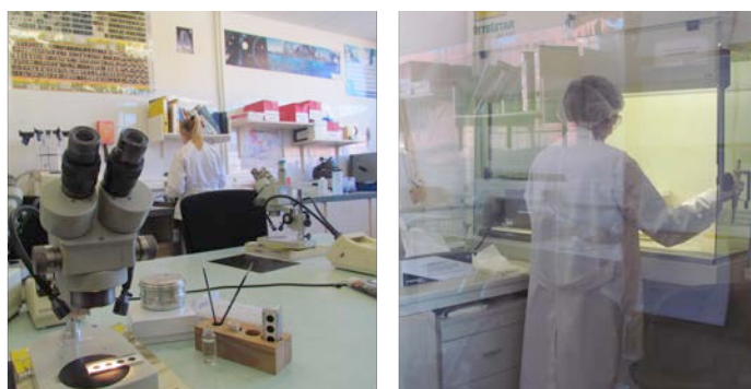
Figura 2.4. Lupa binocular utilitzada en la selecció de foraminífers per realitzar anàlisi d'elements traça i de \delta^{18}\text{O} (esquerra). Sala blanca als laboratoris de la Universitat de Barcelona on es realitza la neteja dels foraminífers pels anàlisi d'elements traça (dreta).
