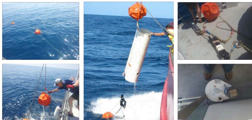
Figura 2.6. Desplegament de l'ancoratge instrumental (mooring) al golf de Lleó.
