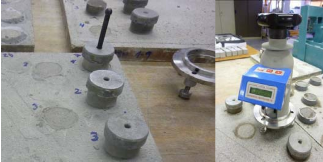
Figura 7.13 Muestras de CBPC adheridas al terrazo con las sufrideras enganchadas (izquierda). Ensayo de tracción con medidor de adherencia electrónico (derecha)
