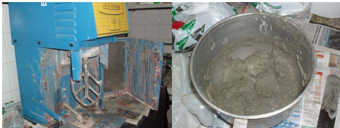
Figura 5.8 Amasadora de morteros (izquierda) y recipiente de mezcla (derecha)
