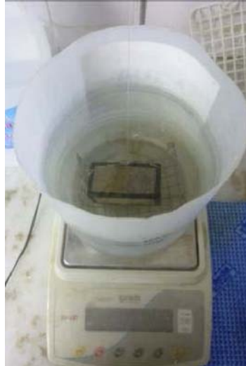
Figura 7.3 Peso hidrostático de la probeta saturada
