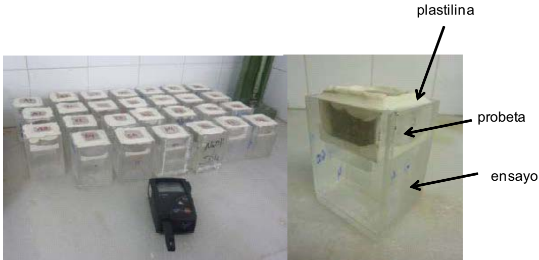
Figura 7.34 Cubetas de ensayo de permeabilidad de vapor de agua (izquierda). Detalle de una cubeta y probeta ensayada (derecha)
