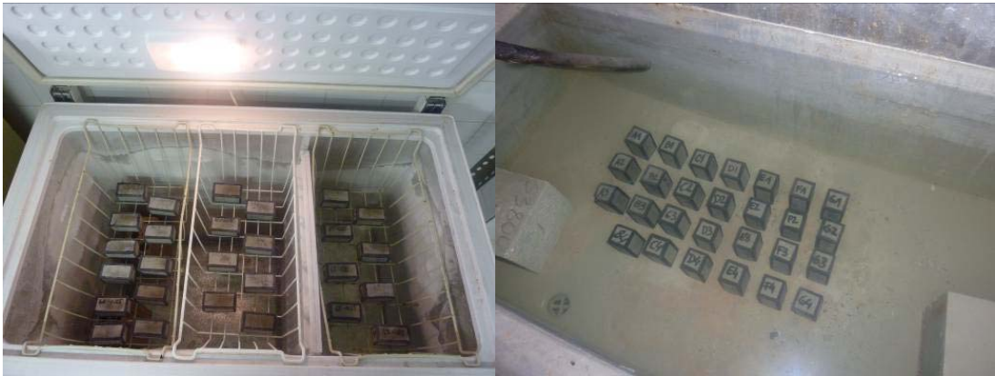
Figura 7.23 Congelación de las probetas (izquierda) y descongelación en baño de agua (derecha)
