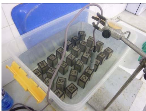
Figura 7.28 Limpieza de las probetas de sales y control de la salinidad con conductímetro
