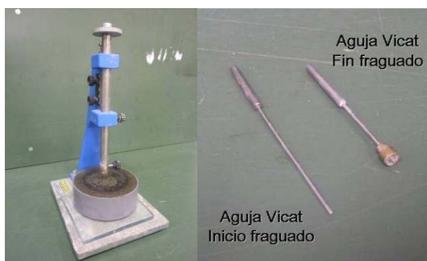
Figura 6.2 Aparato Vicat (izquierda) y agujas empleadas (derecha)
