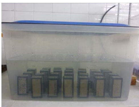
Figura 7.27 Probetas sumergidas en solución salina
