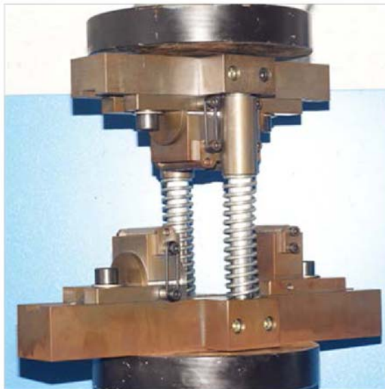
Figura 7.19 Dispositivo de ensayo a flexo-tracción de 4 puntos
