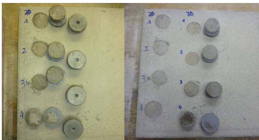
Figura 7.18 Detalle de las probetas 60LG0.25HB ensayadas por tracción indirecta, 2 días (izquierda) y 7 días (derecha)
