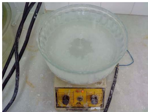
Figura 7.26 Preparación de la solución salina de \text{Na}_2\text{SO}_4
