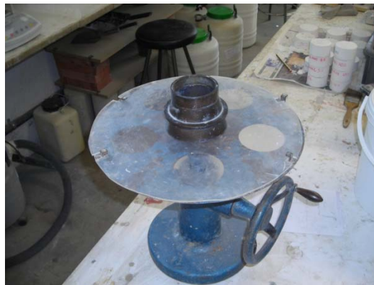
Figura 5.10 Mesa de sacudidas y molde para la realización del ensayo
