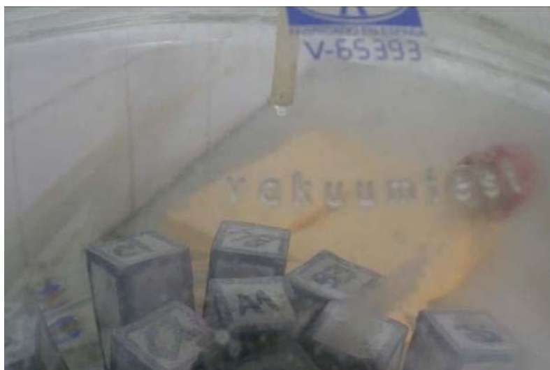
Figura 7.2 Detalle del goteo dentro de la campana de vacío
