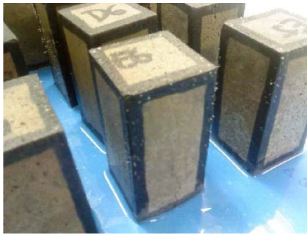
Figura 7.29 Detalle de la salida de la sal del interior de las probetas
