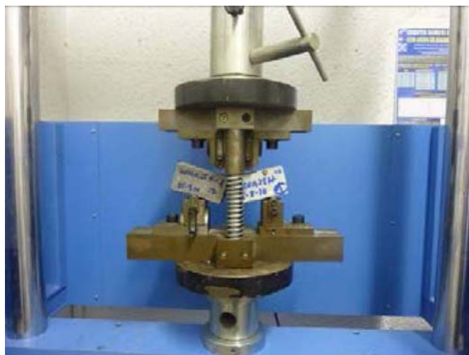
Figura 7.20 Ensayo de la resistencia a la adhesión por flexo-tracción a 4 puntos
