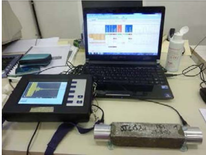
Figura 7.10 Medición del MOE por ultrasonidos
