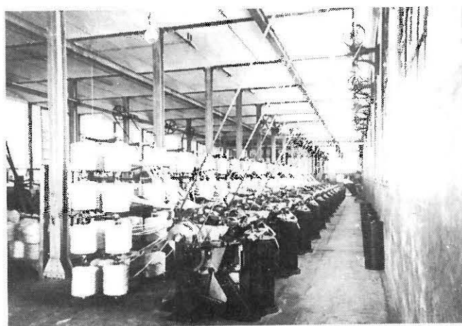
Fot. 10. Amb dues fotografies corresponen a "la Lanera Española". En aquestes màquines es va elaborant el que després serà fil. Tant en l'una com en l'altra s'ajunten diverses fibres per sortir-ne una de sola. en la nº 10, que té el nom de "pentinadora", entren setze fibres per sortir-ne una. Serveix per a les barreges de fibres i per aprimar-les.
