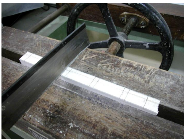
Serrat del bloc per obtenir els orificis pel cosit
