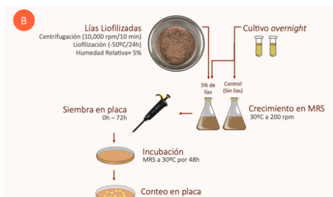
Figura 2. Diseño experimental de la evaluación in vitro del efecto de las lías (5% p/v) sobre el crecimiento de L. sakei .
