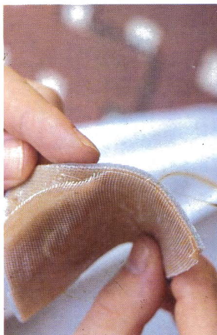
Fig. 22 Resinas fusionadas al calor y vacío.
