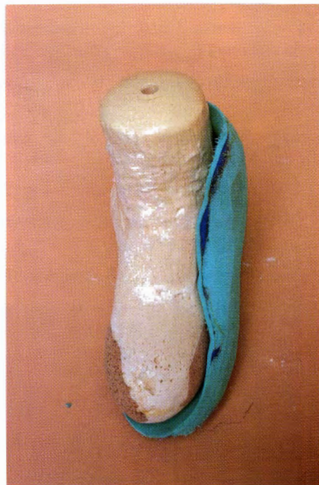
Fig. 32 En esta posición se obtendrá el molde negativo de la horma.
