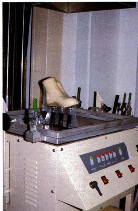
Fig. 33 Adaptación del PVA sobre el molde y plantilla.
