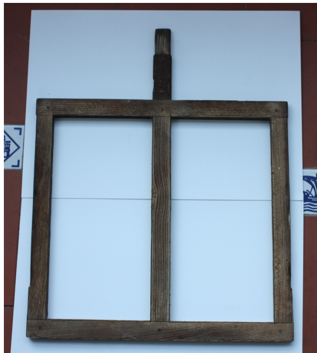
Fig. 171, 172 i 173. Motlles del segle XIX de fusta de melis, un de totxos de 30 x 15 x 5 cm.; un altre de cairons de 25 x 25 cm.; i un darrer de rajoles de 30 x 5 x 2 cm. Imatge: A. Brengaret i Framis, col·lecció particular.
