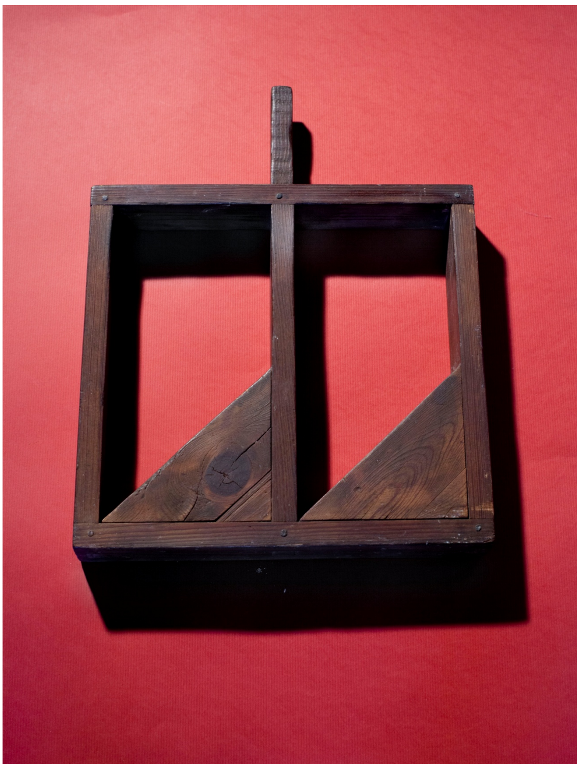
Fig. 170. Motlle dissenyat per l'arquitecte Antoni Gaudí, perquè els rajolers Antoni i Carles Framis i Pellicer li fabriquessin les peces a la seva bòbila. Motlle de la col·lecció particular d'A. Brengaret i Framis.
