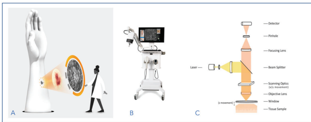
Figura 4. A. Microscopio confocal in vivo: visualización instantánea de la piel con resolución celular; B. VIVASCOPE 1500 y 3000®; C. Mecanismo de funcionamiento del confocal. (Fuente: VivaScope www.vivascope.de )
