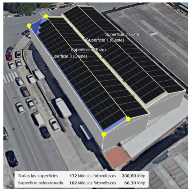
Figura 5: Representació en 3D de l'edifici objecte d'estudi, amb el dimensionament màxim dels mòduls solars seleccionats.
