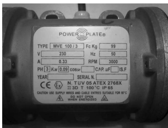
Figura 2-14. Placa de especificaciones técnicas del motor MVE 100/3.
