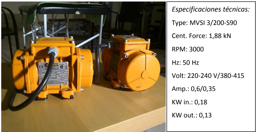
Figura 2-2. Pareja de motores vibratorios trifásicos (Italvibras MVSI 3/200-S90) utilizada en el desarrollo del prototipo I.
