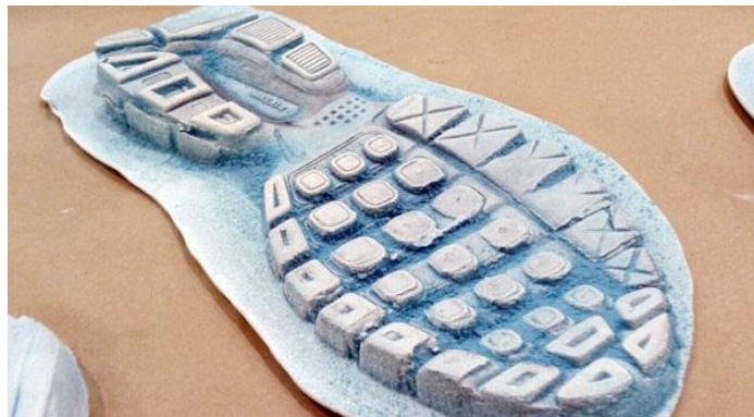
Figura 2.4.3.1 Molde de yeso de la suela del calzado (18)
