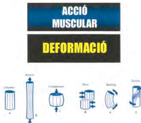
Figura 14. Tota força aplicada a un cos genera un cert grau de deformació (Watkins, 1999).
