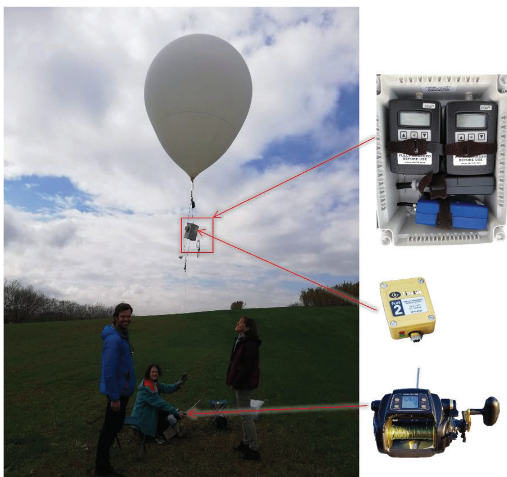
Figura 28. Imatge del mostreig en alçada amb globus captius i els instruments utilitzats.
