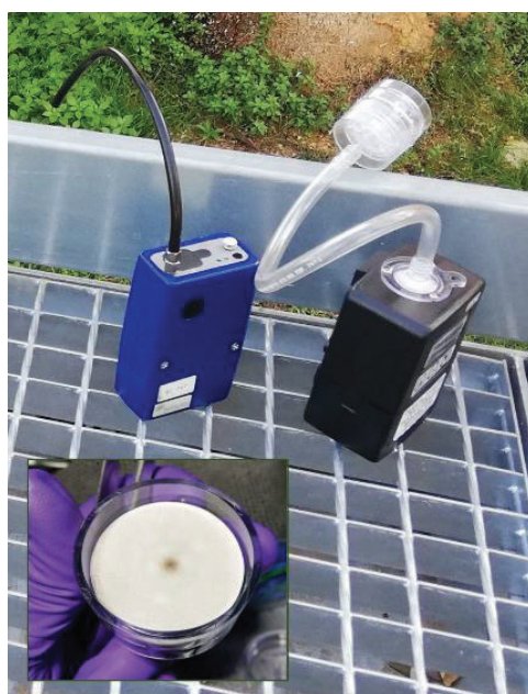
Figura 27. Imatge del aetalòmetre AE51 (blau), la bomba AirChek XR5000 (negre) i els filtres de volum baix recollits.
