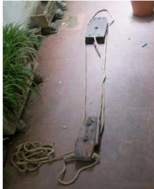
Palanquí. Sistema de politges utilitzat per retirar les barques de l'aigua manualment. Fotografia: Josep Montmany, A Tot Drap
