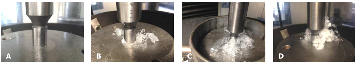
Figura 6.8 Fluidez a compresión de los diferentes lubricantes a 40°C a una velocidad de 1mm/min. Resultados finales del ensayo a compresión realizado a: A) ZnSt y la cera, B) el Lube PM, C) el GMS y en D) la erucamida.
