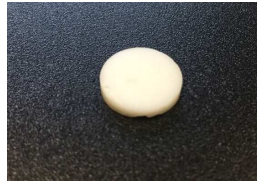
Figura 3.9 Tipo de probeta conformada para el análisis por AFM de las propiedades nanomecánicas de cada lubricante evaluado.
