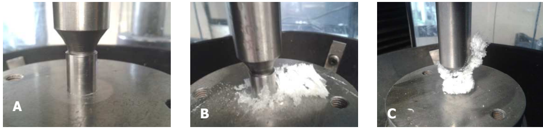
Figura 6.10 Fluidez a compresión de los diferentes lubricantes a 60°C a una velocidad de 1mm/min. Resultados finales del ensayo a compresión realizado a: A) ZnSt y la cera, B) el Lube PM y C) la erucamida.
