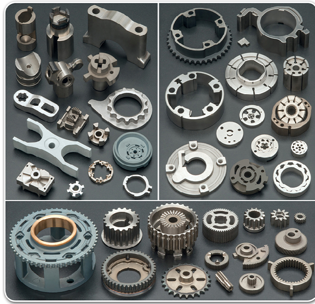
Figura 1.2 Componentes estructurales sinterizados de acero.
