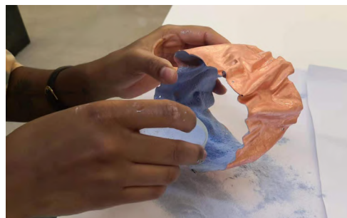
Esmaltado por tamizado en seco Imagen de la autora
