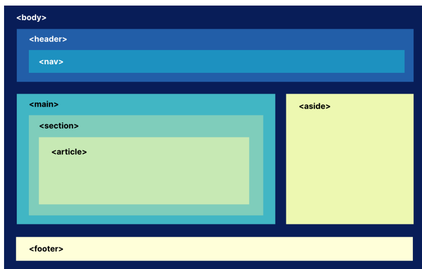
Figura 72. Elementos estructurales semánticos de HTML5
