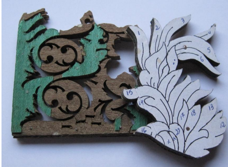
83 Paquets de xapes vogides amb la numeració dels colors de les xapes sobre la mariona, les puntes de subjecció i la superposició dels materials.
