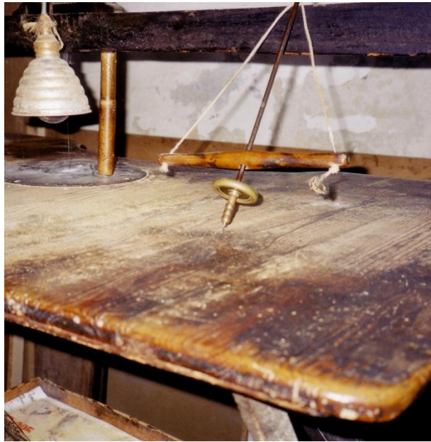
76 Finíssim filaberquí per foradar les xapes sense danyar-les
