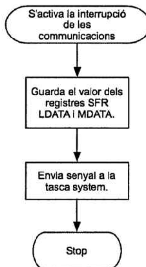
Figura 6.68: Diagrama de flux de la ISR de la interrupció de les comunicacions.
