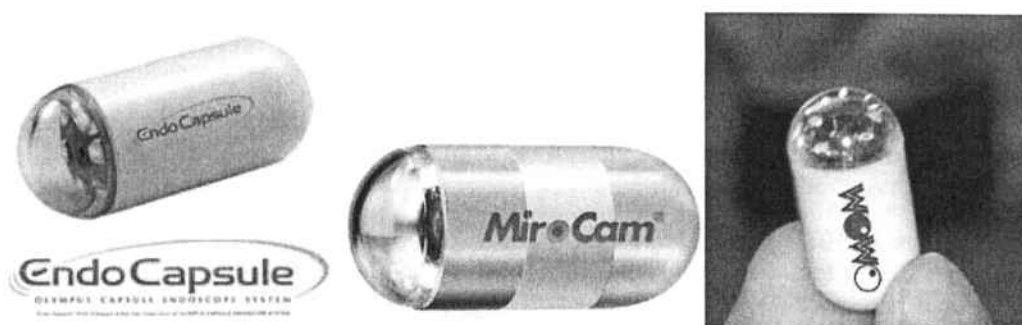
Figura 3.3: Càpsules endoscòpiques d'esquerra a dreta EndoCapsule , MiroCam , OMOM .
