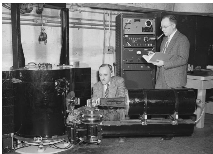
Clifford Shull (dreta) i Ernest O. Wollan amb un espectròmetre de neutrons de doble cristall, al reactor ORNL X-10 de grafit, el 1949.
