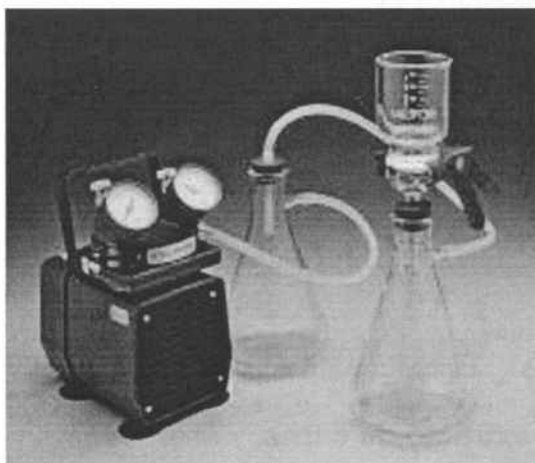
Figura 3.13. Montaje para recoger la muestra prefiltrada.
