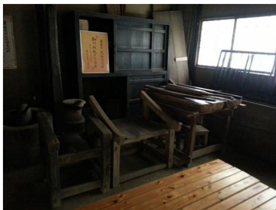
36. Taules on s'estova mecànicament la fibra
