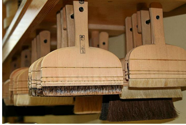
89. Pinzells per aplicar la cola de midó- Font: Nihon Shuji Kyoiku Zaidan Foundation ( www.kampo.com )
