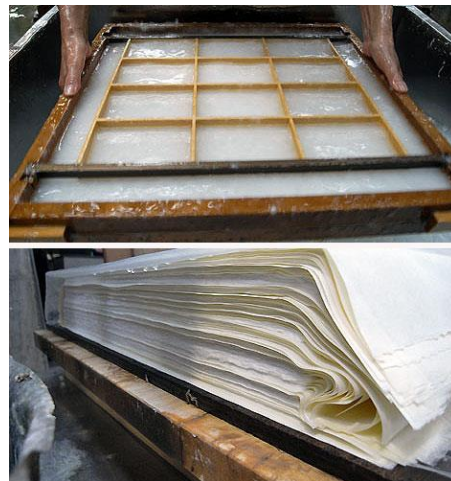
42. Motlle per fer el foli i folis secs apilats
