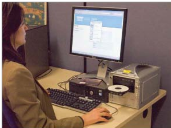
Figura 24. Unitat personalitzada per a la duplicació de CD-ROMs a la NLA
