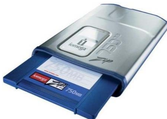
Figura 66. Unitat Zip externa i disquet Zip de 750 MB (Iomega)
