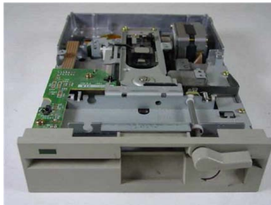
Figura 62. Part frontal de la unitat de disquet de 5 ¼ TEAC FD-55GFR
