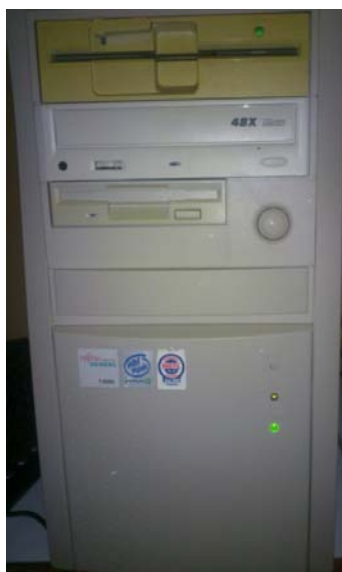
Figura 56. Ordinador 'Rosetta' amb unitats de disquet instal·lades
