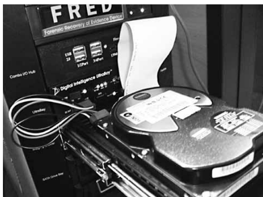
Figura 23. Creació de la imatge d'un disc dur mitjançant una unitat FRED
