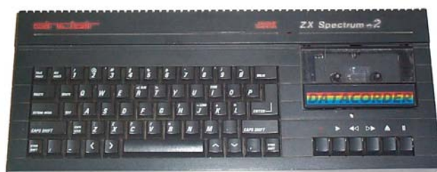
Figura 12. Ordinador ZX Spectrum amb lector/gravador de casset incorporat
